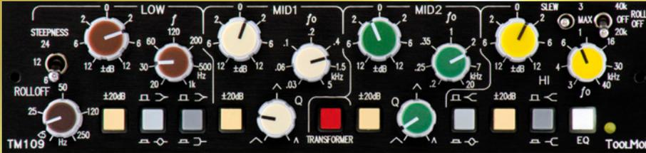
**Nicht nur für Vocals** TM109 Voice-EQ mono, vier Bänder, regelbare Tiefensperre, umschaltbare Flankensteilheit im Shelving-Betrieb, zuschaltbarer Übertrager, High-Roll-Off und umschaltbarer Slew Rate
