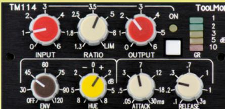
**Vintage-Style** TM114 FET-Compressor, symmetrisch aufgebaute Regelung und Side-Chain-Processing
